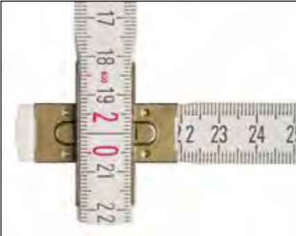
Серия 600 Шарнирные пластины из высокопрочной листовой стали со встроенной пружинной из закаленной стали и скрытой заклепкой
