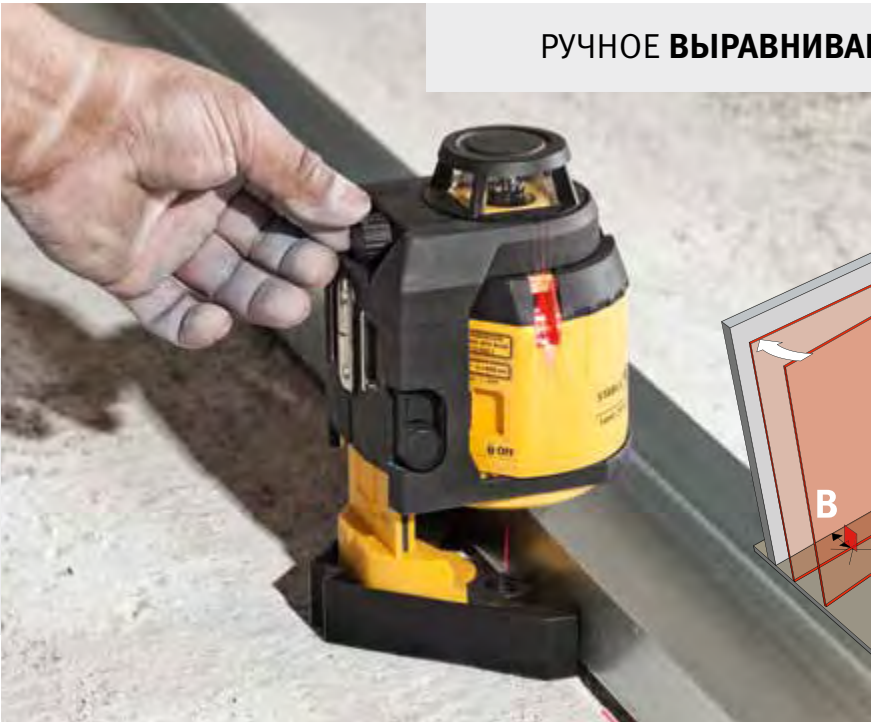
1) Положение для транспортировки. 2) Подвижную часть прибора можно поворачивать внутри корпуса на 360°. 3) Благодаря регулируемой по высоте ножке можно изменять высоту лазерной линии. Нижняя опорная часть прибора позволяет устанавливать его, например, на U-образные металлические профили для сухой штукатурки.
